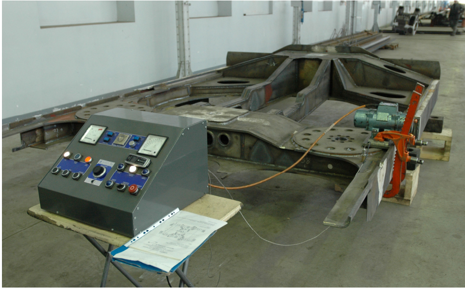
Fig.5. Stanowisko do odprężania wibracyjnego czołownicy pojazdu szynowego.
